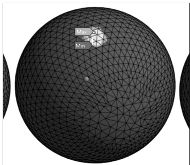
Hình 6. Vị trí ứng suất von-Mises cực đại ở tải 3 kN
