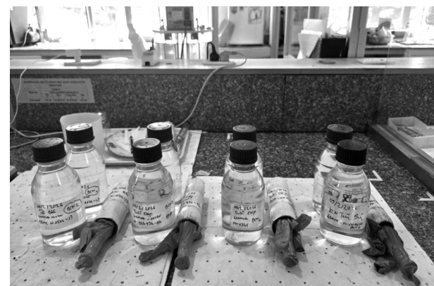
Hình 2: Mẫu dầu OLTC của các Trạm 110kV: Tân Biên 1 máy, Suối Dộp 2 máy, KCN Trảng Bàng sau khi đại tu bảo dưỡng thay dầu và sấy lọc
