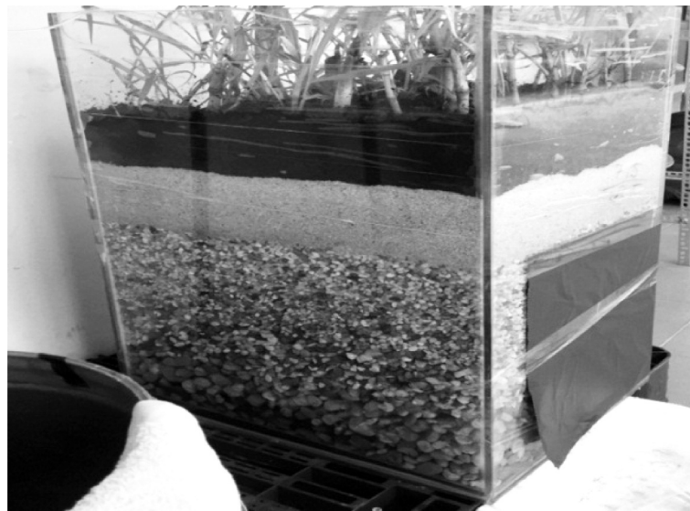
Hình 2: Các lớp vật liệu trong mô hình ĐNNKT
