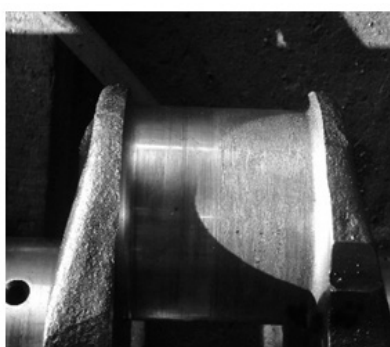
Hình 6: Cổ trục khuỷu động cơ bị mài xước nghiêm trọng
