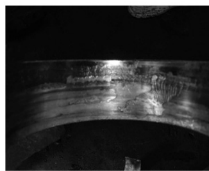
Hình 7: Bạc lót động cơ bị cháy dẻo
