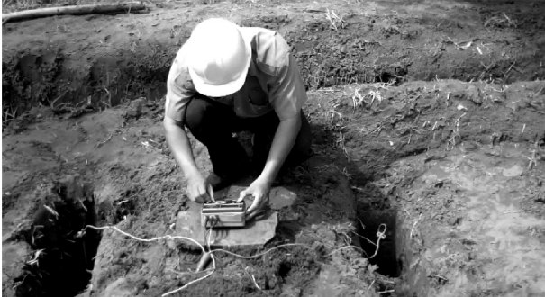
Hình 7: Hai cọc, a = 4 \text{ m} , L_C = 1\text{m} , d = 0.01\text{m}
